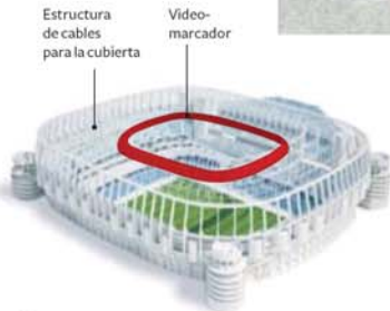
El revestimiento es permeable y permite la ventilación natural de los espacios de circulación.
